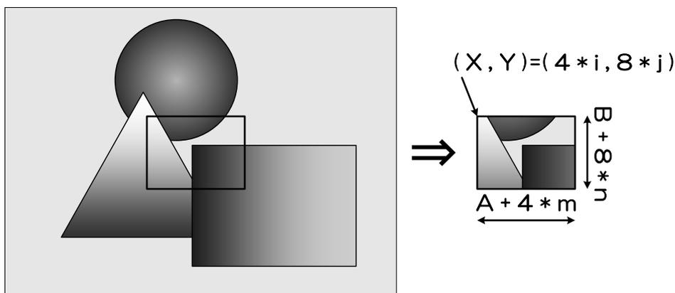
スケーラブルモードではカメラ内部にてウィンド部分のみを標準の速さで読み出し、ウィンド以外の不必要な部分を高速で読み飛ばします。このため垂直方向（縦方向）のウィンドが小さい場合は、フレームレートが向上します。
