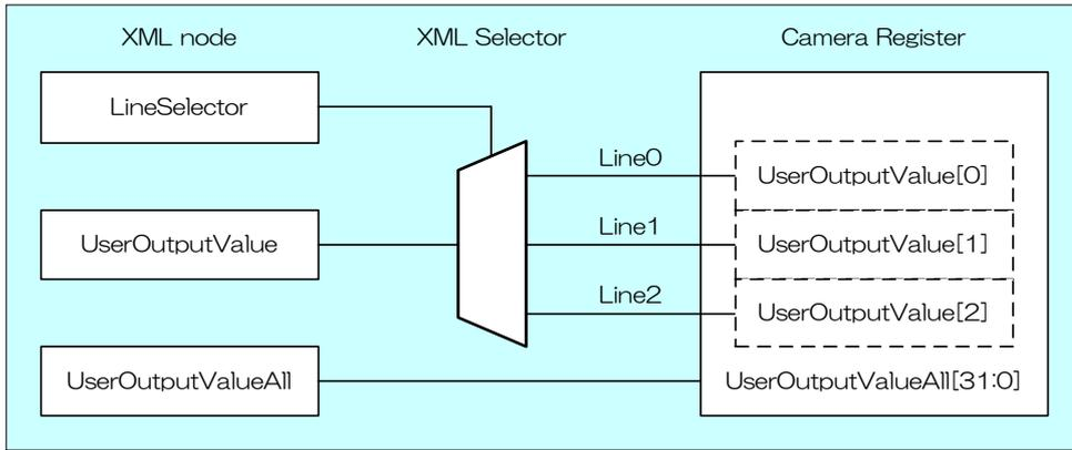
UserOutputValueAll によって Line 出力のユーザー設定値を設定します。
