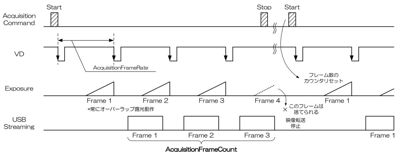
**-MultiFrame 動作 (ランダムトリガシャッターモード : TriggerMode = On, TriggerSequence = 0 or 1)**
