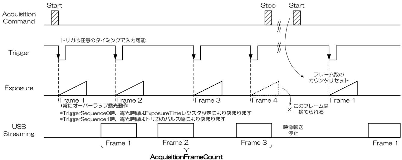
**-Bulk モード動作 (ランダムトリガシャッターモード : TriggerMode = On, TriggerSequence = 6)**
