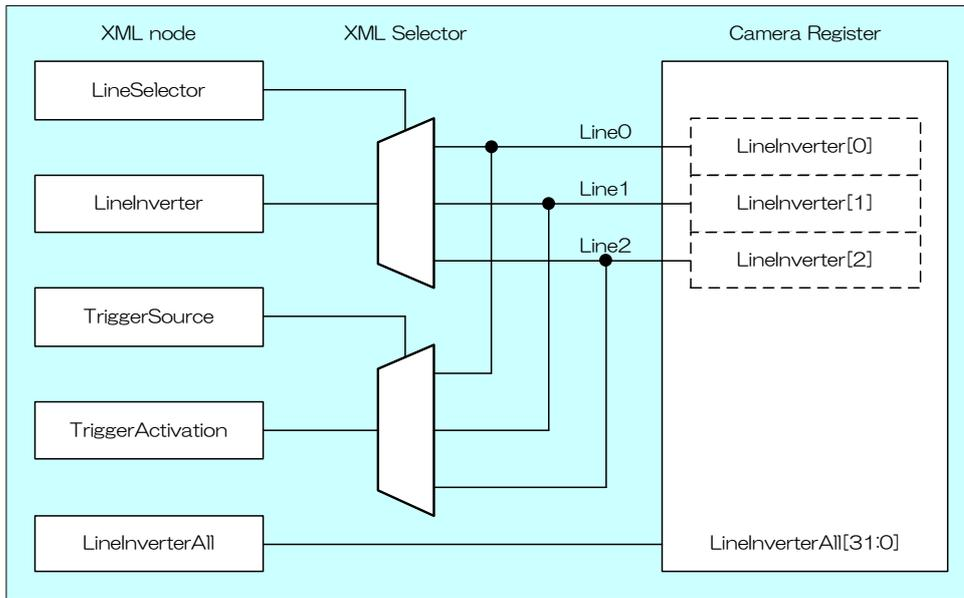
LineInverterAll によって各 Line の極性を選択します。
