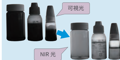
濃い液体の液量・異物混入検査 左から: コーヒー・うがい薬・インキ
