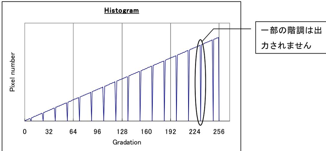
Fig 7. 本機の階調出力例(8bit 出力)
