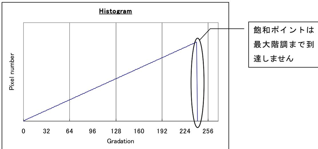
Fig 7-1. 階調補正機能例(8bit 出力)
