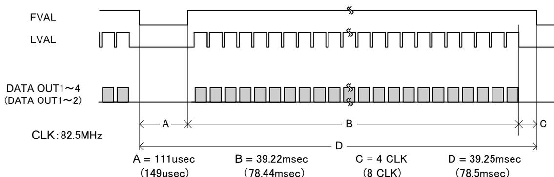
注：シャッターON時はシャッタースピードに応じてフレームレートが変化します。
