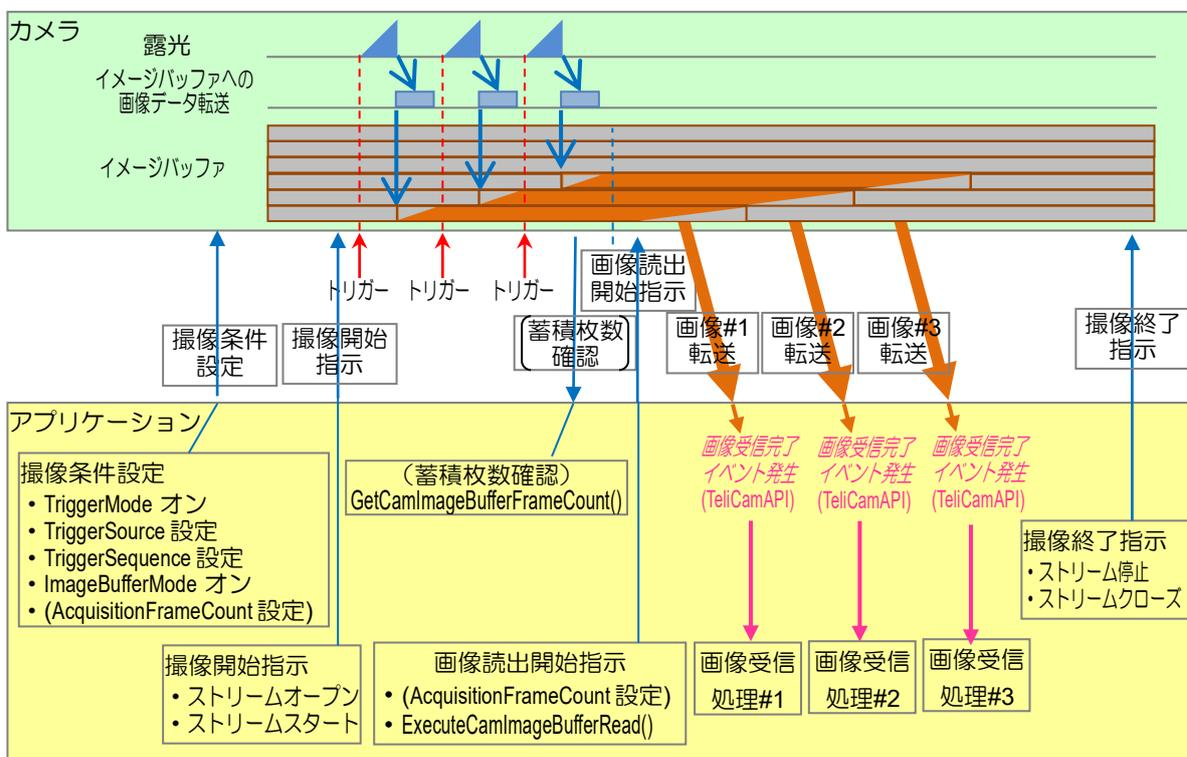
ImageBuffer モードの画像取得処理は以下の点以外は通常の画像取得処理と同じです。
