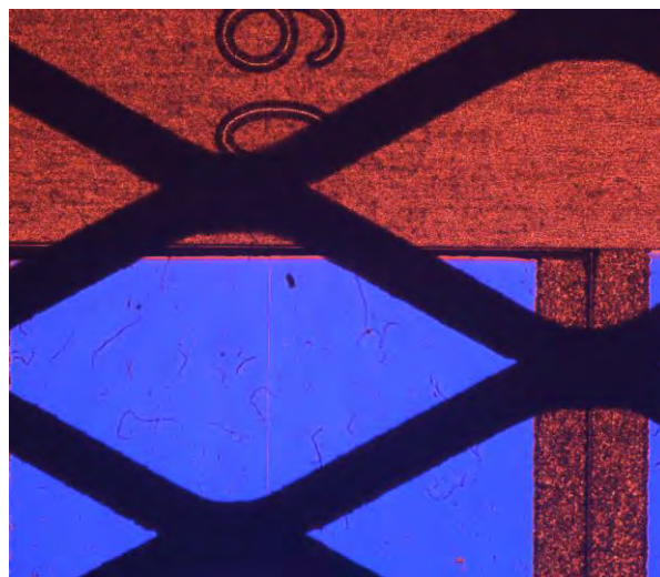
【Scratch #60】(精密グレード) キズ線幅：約6~60 \mu\text{m} 相当 露光時間：5000 \mu\text{s}
